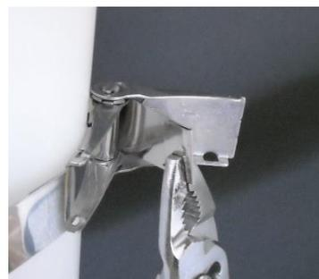
5. レバーを何回か前後に動かして、スチールベルトを巻き上げる。右図③をご参照ください。
