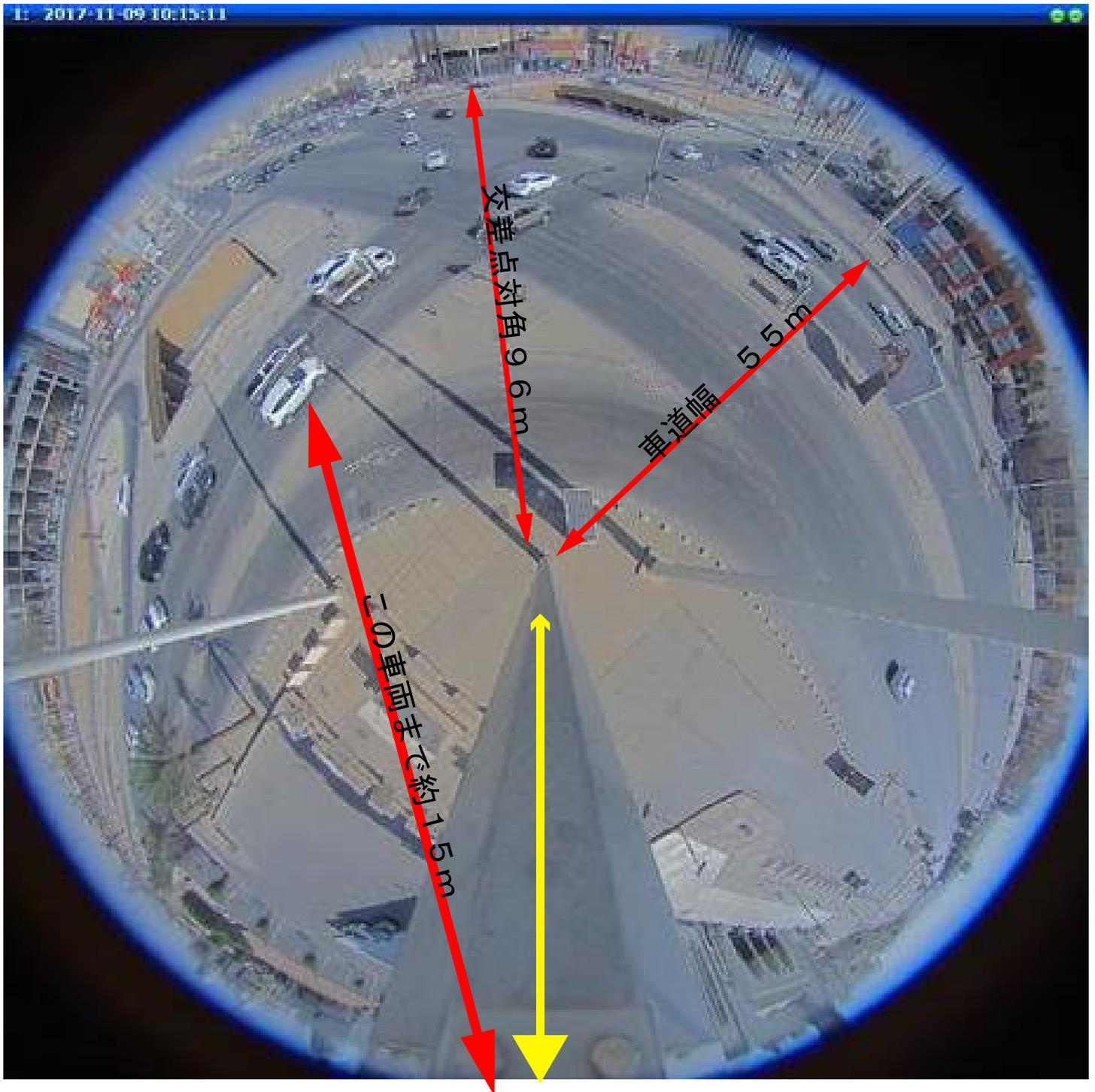
高さ 12m の支柱に下向き設置
